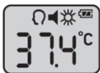
Ako je temperatura ispod  $37,5^{\circ}\text{C}$ , uključuje se zeleno pozadinsko osvetljenje.
